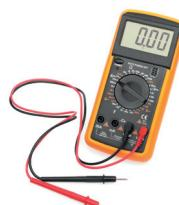
Bom, neste caso a condição do cabo de ignição pode ser avaliada por meio de testes. O multímetro, por exemplo, é uma ferramenta utilizada para verificar a resistência da peça.
