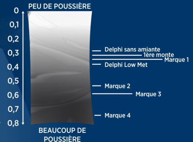
Les véhicules, conduits en convoi, ont parcouru un **circuit de 200 km** combinant les défis de la **conduite en montagne** et **en ville**, chaque boucle prenant **210 minutes**. Pendant **dix jours**, chaque voiture a effectué **deux circuits par jour**, assurant un test minutieux et exhaustif des **émissions de poussières des plaquettes de frein**.
